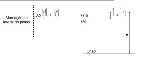
Esquema para fixação na parede x= Distância do chão de acordo com a necessidade.
